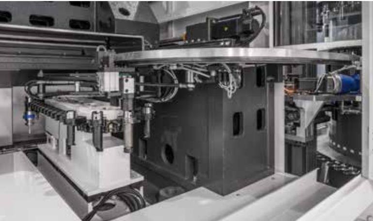
Ständig wachsende Marktanforderungen bezüglich der maximal möglichen Einsatzflexibilität moderner Werkzeugmaschinen setzen zwingend voraus, dass eine Maschine in kürzester Zeit auf neue Fertigungsaufgaben umrüstbar sein muss. Die Schlüsselrolle spielt dabei der schnelle Zugriff auf die Werkzeuge und Werkstücke. Sind die notwendigen Werkzeuge und Werkstücke für die Bearbeitung jederzeit und sofort verfügbar, kann die Umstellung der Maschine auf eine neue Fertigungsauf-
