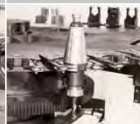
Vertikales Fräswerkzeug BT
