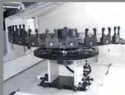
Automatischer Werkzeugwechsler mit bidirektionaler Werkzeugwahl erhöht die Produktivität der Maschine.
