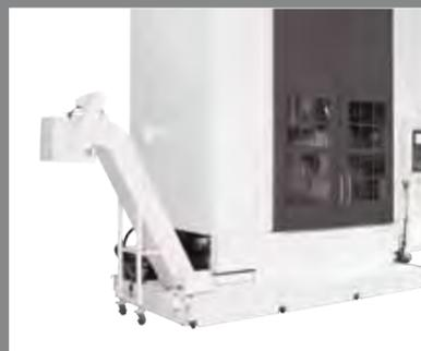
Schnelle Späneförderer in Scharnierband-Ausführung garantieren einwandfreie Entsorgung der anfallenden Späne, auch bei großvolumiger Zerspannung. Der Kühlmittelkanal ist unter der Maschine integriert.
