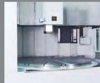
Stabile Teleskopabdeckungen aus Stahl schützen die Bahnführungen und gewährleisten eine dauerhafte Genauigkeit der Maschine.
