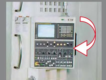
Das ergonomisch konzipierte Bedienpult ermöglicht die einfache und ermüdungsfreie Bedienung der Maschine. Eine Verlängerung des Bedienpults ist das elektronische Handrad, das sämtliche Einrichtarbeiten erleichtert.
