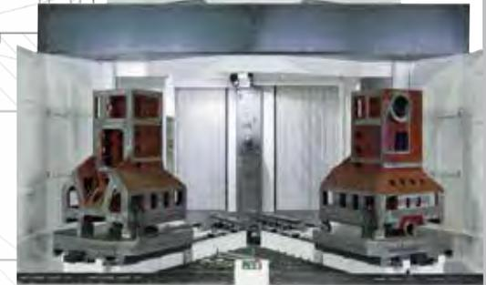
Shuttle-Palettenwechsler HZ 1000 / 1250
