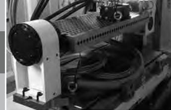
Bestückungsbeispiel 4. NC-Achse mit Gegenlager und Schwenkbrücke
