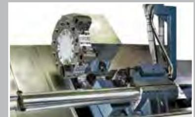
Reitstockaufnahme für lange Bohrstangen
