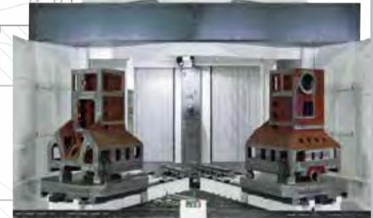
Shuttle-Palettenwechsler HZ 1000 / 1250
