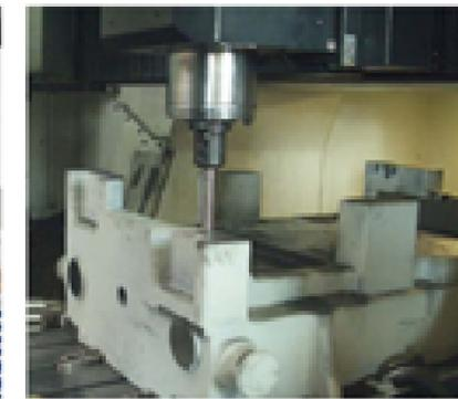
Einzelteilfertigung ist eine Domäne des jungen Unternehmens. Mit der Wemas YZP 1600 lassen sich auch größere Werkstücke bearbeiten.
